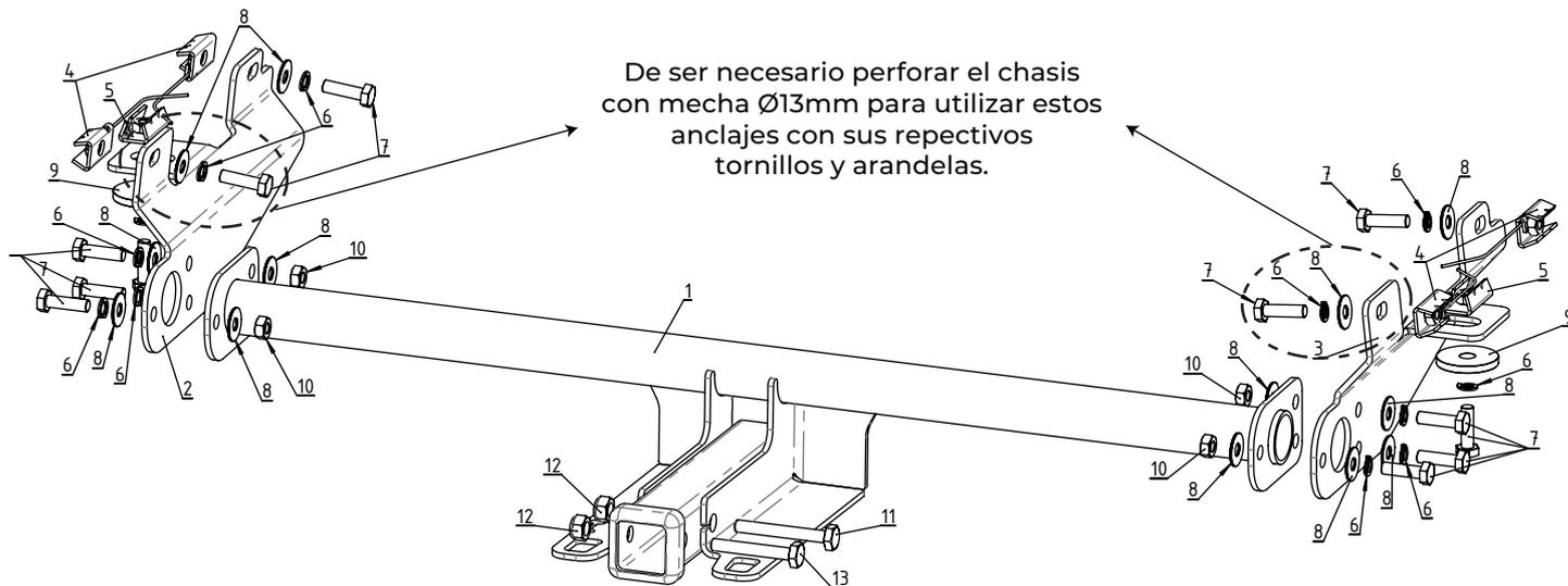
De ser necesario perforar el chasis con mecha Ø13mm para utilizar estos anclajes con sus respectivos tornillos y arandelas.
